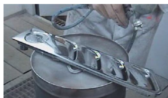
3. Acabado efecto cromo. Secado en cabina y barnizado
